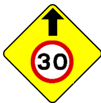
รูปที่ 8 ป้ายเตือนลดความเร็วจำกัด
